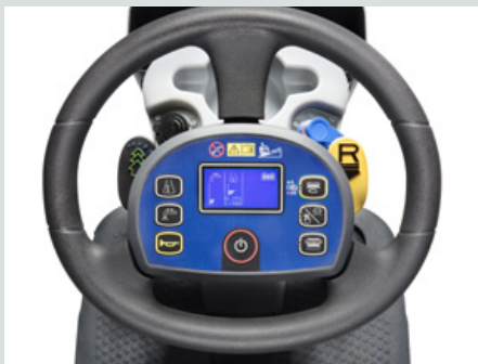
直观的仪表板，配有一键式按钮和内置 LCD 显示屏
