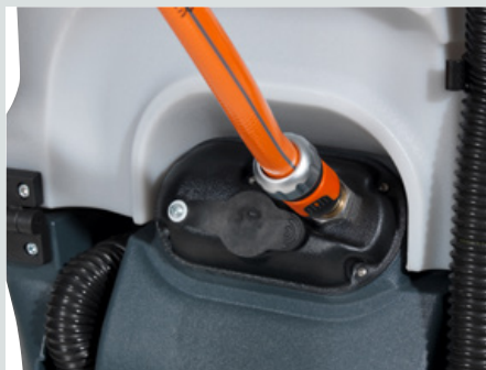
水箱满时自动关闭的加注系统（可选）
