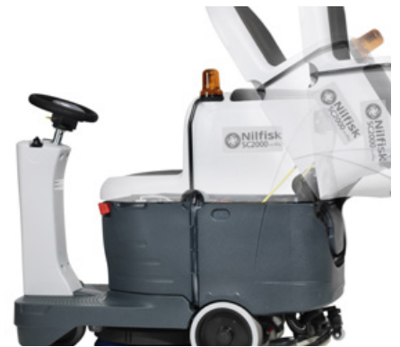
完全倾斜式污水箱，便于使用电池舱和 Ecoflex 系统
